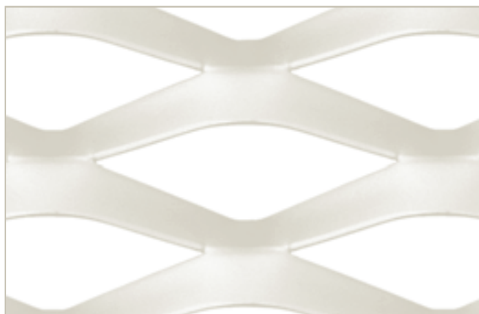
Maglia/Mesh: GATE 76 x 31 (35) - 11 x 2 mm (Pag. 90) Alluminio/Aluminium
