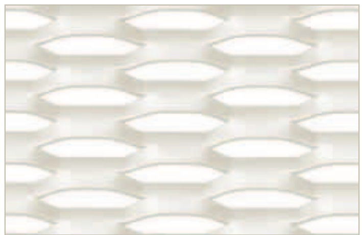
Maglia/Mesh: FILS 21-S 45 x 15 (13,4) - 5 x 1,5 mm (Pag. 88) Acciaio al carbonio zincato a caldo/Hot dip galvanized steel
