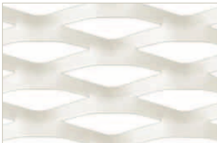
Maglia/Mesh: FILS 5 62,5 x 20 (20) - 7,5 x 3 mm (Pag. 88) Alluminio/Aluminium
