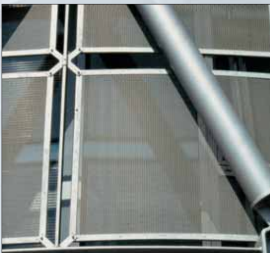
TIPO 25 - DL 28 x DC 10 (10) - av 1,5 - sp 1,5 mm Hierro prégalvanizado y lacado con polvo de poliéster para exteriores
