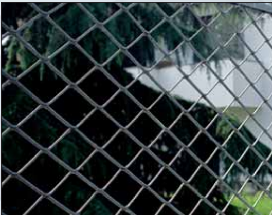
LD Q 120 x CD 87 (80) - l 6 - e 4 mm Acier thermolaqué par poudrage polyester pour l'extérieur
