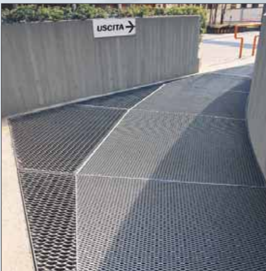
FILS 6 - LD 90 x CD 30 (22,3) - l 7,5 x e 4 mm FILS 20 - LD 45 x CD 15 (11,4) - l 3,3 x e 3 mm Acier galvanisé à chaud
